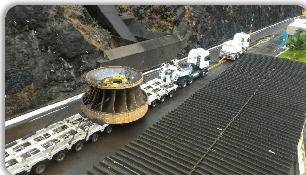
Chegada do rotor da turbina da UG5 da UHE Salto Osório
